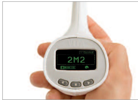
Abb. 4 Am Geräteboden befinden sich das Display und die Bedienschalter. Die Messwerte können im Vitapan classical-System von A bis D angezeigt und nach der 3D Master-Scala mit Helligkeit, Farbton und Farbintensität wiedergegeben werden
